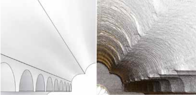
Scan to BIM. L'intradosso della copertura lignea della chiesa degli Eremitani a Padova – Il modello ideale e il modello del reale – P. Borin, M.R. Cundari, F. Panarotto – (di lato)
